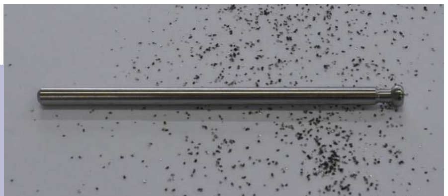
그림 3: 스테인리스 가공 시에도 고압 MQL 시스템을 사용하면 매우 짧은 칩이 형성됩니다. 즉, 공기가 팽창함에 따라 칩이 냉각되어 효과적으로 부서집니다.
