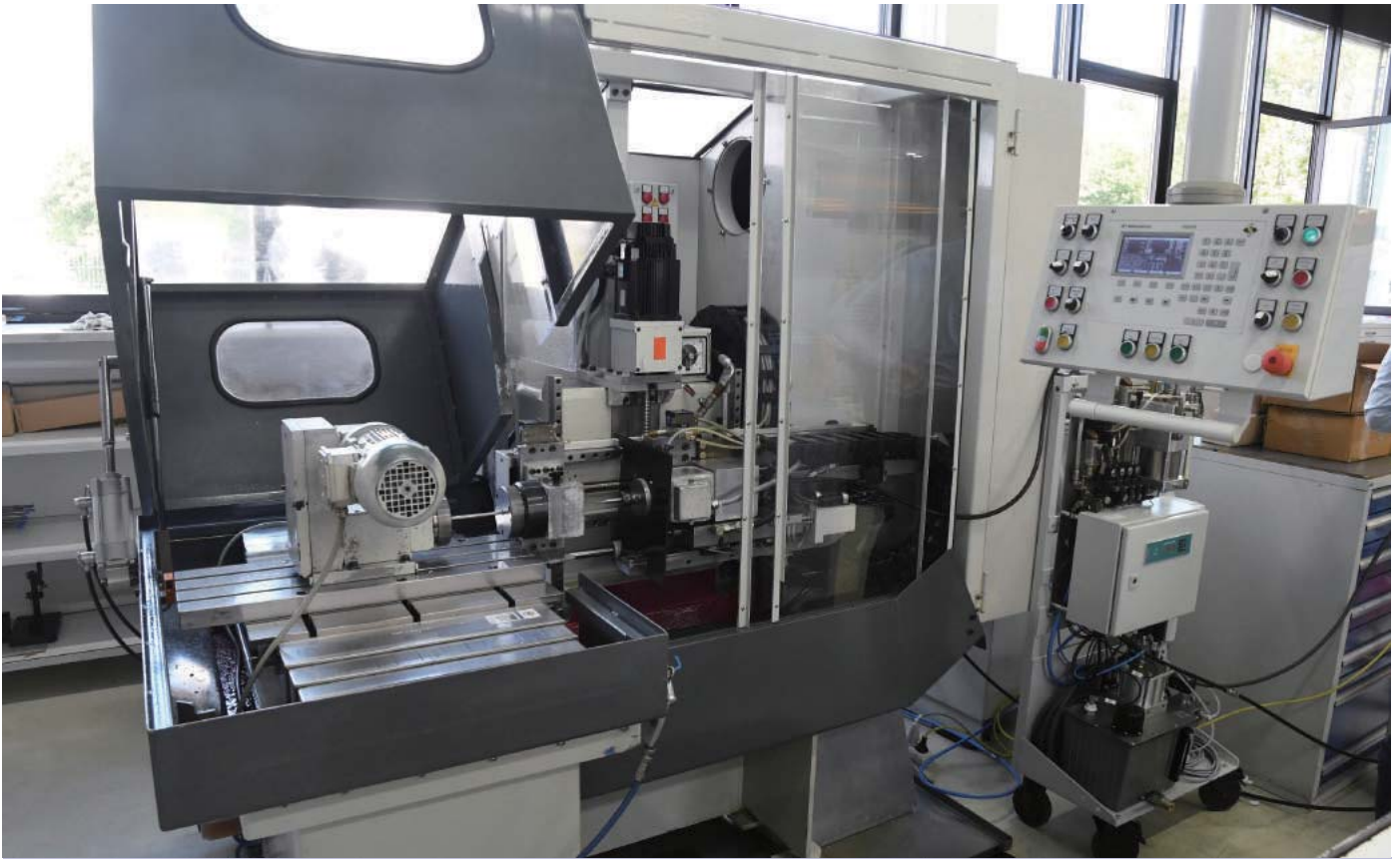
그림 4: 딥 홀 드릴링 머신 TBS200에서 진행되는 스테인리스강 딥 홀 드릴링
