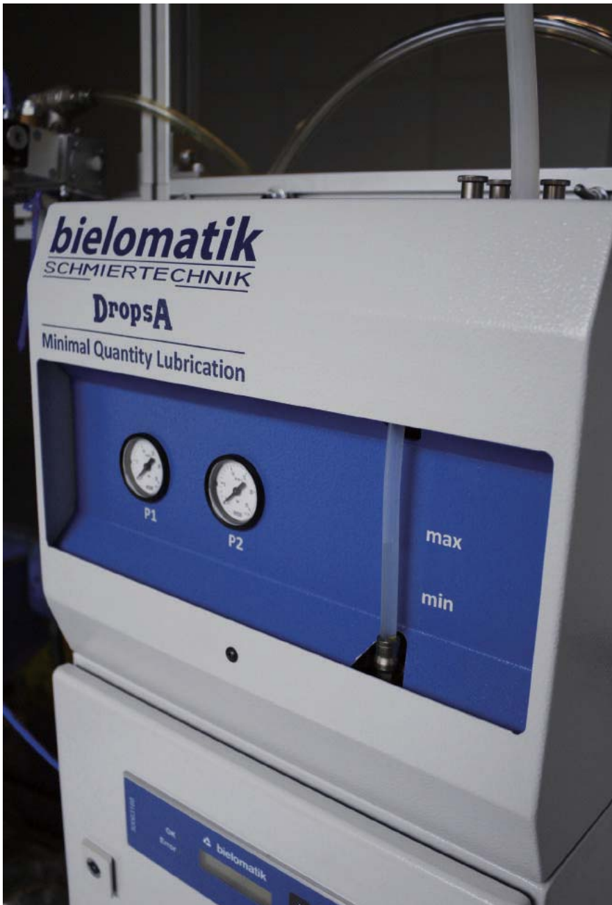
그림 1: Bielomatik의 새 MQL 시스템 - 최대 내부 압력 25 bar (출처: Bielomatik Schmiertechnik GmbH, Frickenhausen)
