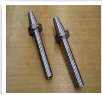
SK-40 x \varnothing 25 x \varnothing 32 x 190
